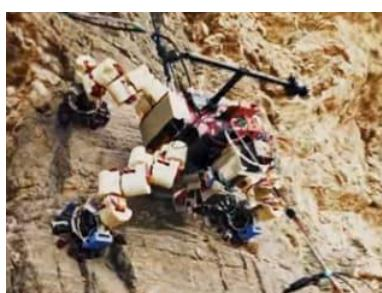
El robot Lemur es un robot con el que la NASA está desarrollando la tecnología que va a emplear en Marte para poder ascender por las paredes más verticales de sus montañas.
