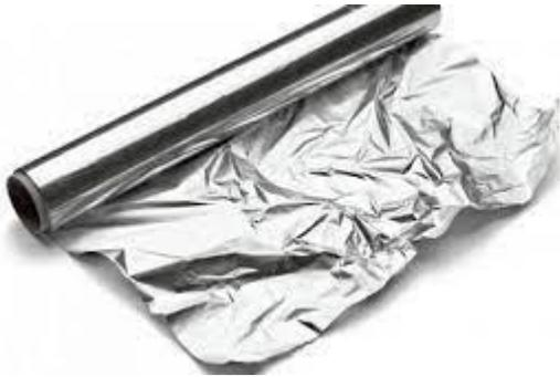
Usos: cables de líneas eléctricas de alta tensión, fabricación de aviones, automóviles y bicicletas debido a su baja densidad (peso). También se emplea en carpintería metálica para fabricar puertas y ventanas, en útiles de cocina y botes de bebidas.
