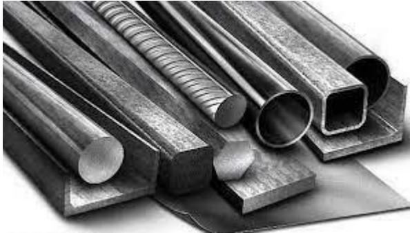
Acero : es una aleación de hierro y carbono donde la cantidad de carbono no supera el 2% de la cantidad en la aleación. Es un material dúctil, tenaz, maleable, se puede soldar fácilmente, conductor térmico y eléctrico. Su mayor problema es que se corroe y oxida fácilmente, por eso se le suele añadir una capa protectora de cromo y/o níquel.
